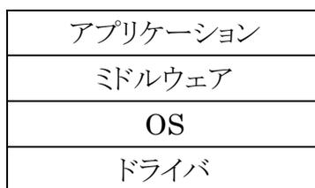
図 8.1 組込みシステムの典型的な構成
