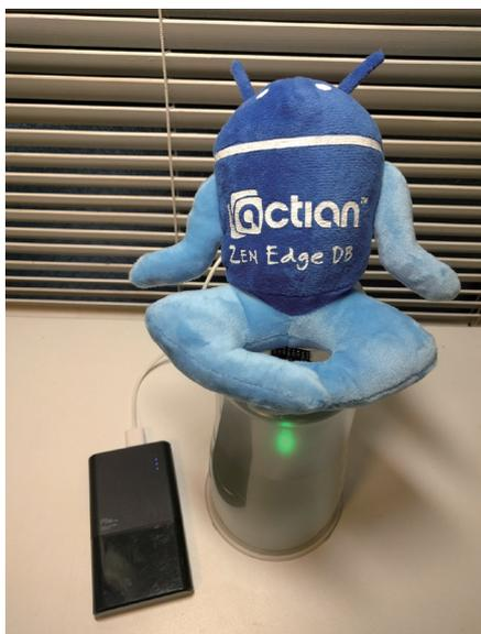
30秒間隔で空気品質をセンサ (CCS811) で監視。酸化炭素相当物 (eCO<sub>2</sub>) および金属酸化物 (MOX) レベルを含む、総揮発性有機化合物 (TVOC) をモニタします。また、別のセンサ (HDC1080) を使用して温度と、湿度をモニタします。取得した値は、AmbientというIoTデータの可視化サービスに送信し、データを蓄積。Webブラウザで送信したデータをグラフ表示してくれるサービスです。LEDの色は、eCO<sub>2</sub>の値が1500未満で緑、1500以上2500未満で黄、2500以上で赤に変化します。2500以上になるとIFTTT (Webサービス同士を連携できるサービス) 経由でLINEに通知して、換気を促します。LINEへの通知間隔は最短で15分に設定しています。スプレーやアルコール等、揮発性のあるものに敏感に反応します。
